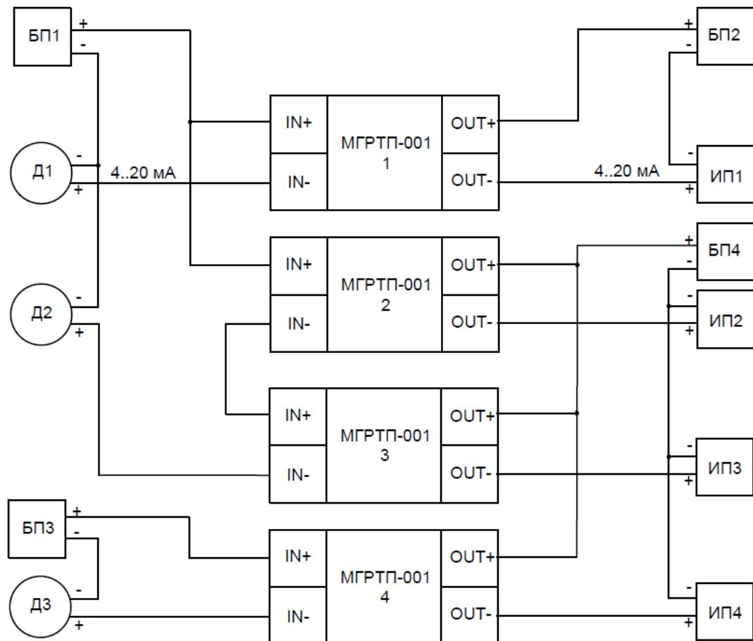
Рисунок 4 - Смешанная схема подключения модулей МГРТП-001
