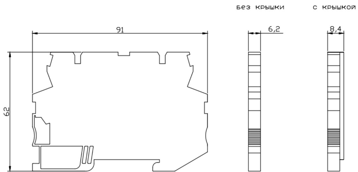
Рисунок А.1 —Конструкция МГРТП-001
