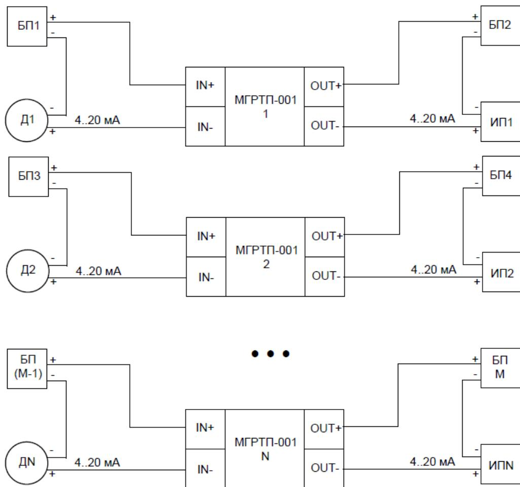
Рисунок 2 - Раздельная схема подключения модулей МГРТП-001
