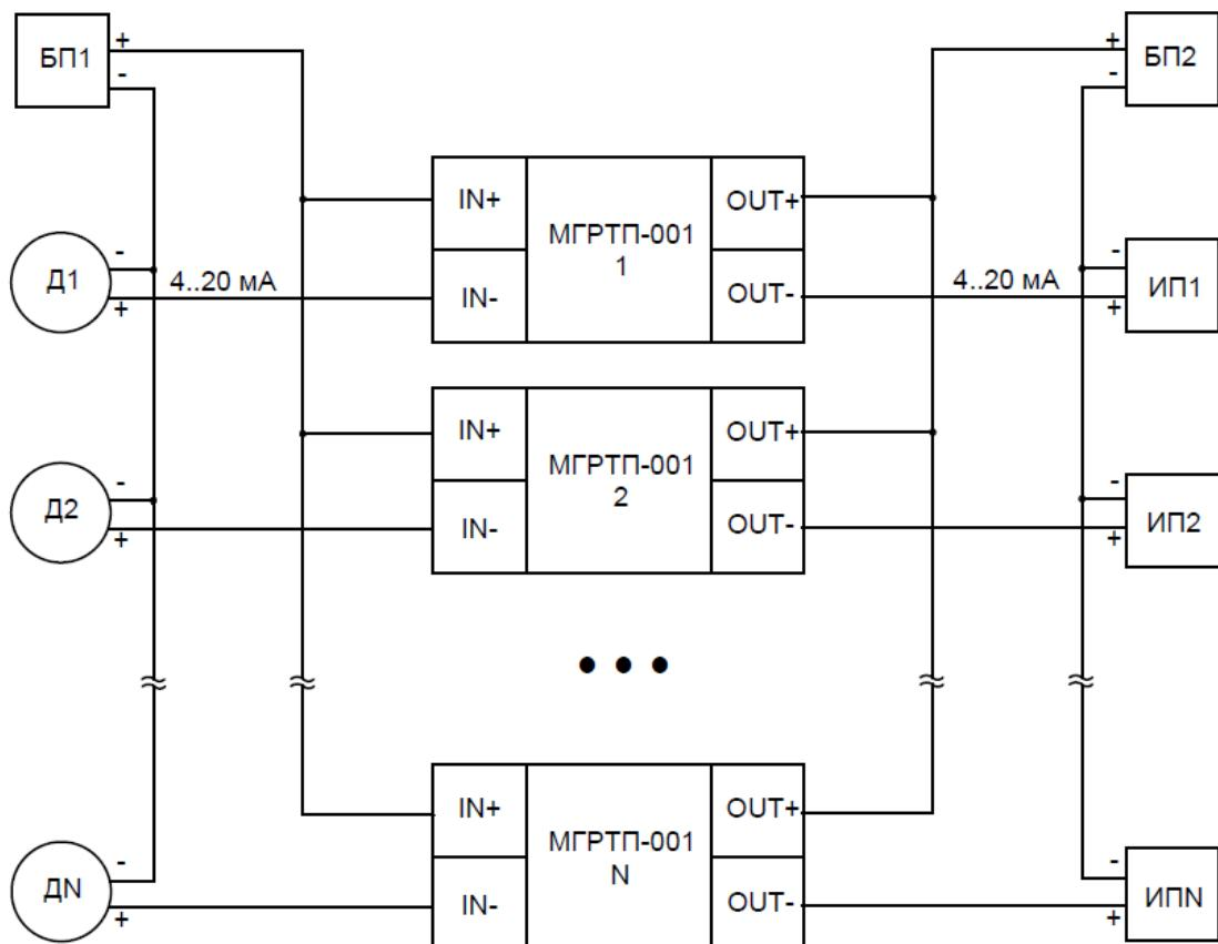
Рисунок 1 - Типовая схема подключения модулей МГРТП-001
