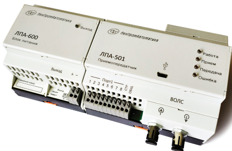
Рис. 2. Приемопередатчик ЛПА-501 с блоком питания ЛПА-600
